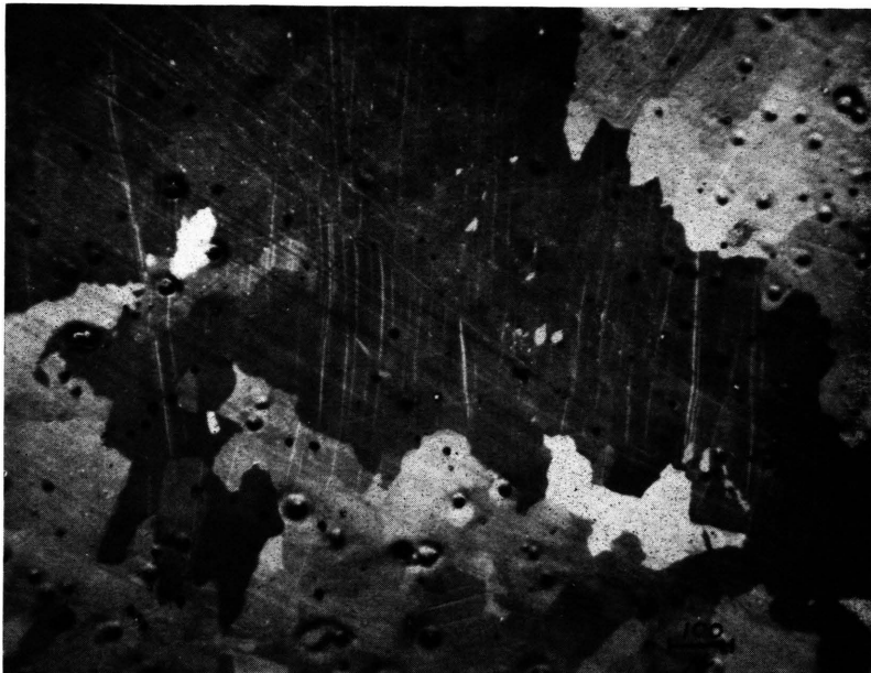
Abb. 1. Uran C, zweimal im Vakuum und \text{Al}_2\text{O}_3 -Tiegel umgeschmolzen, Vergrößerung 75-fach.
